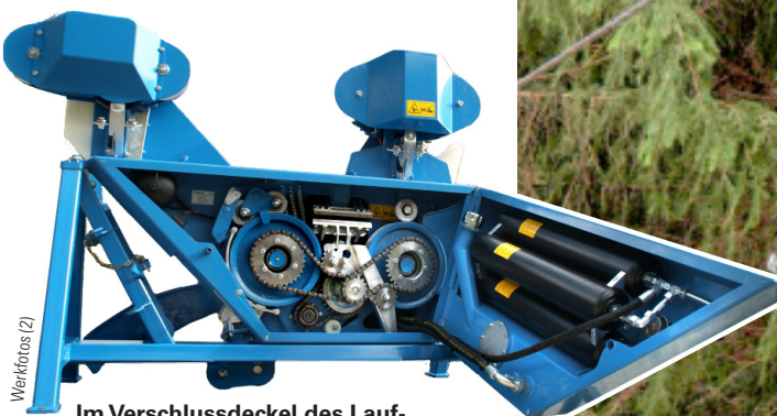
Im Verschlussdeckel des Laufwagens befinden sich die drei Druckspeicher, die für sicheres Ausspulen des Zugseils zuständig sind
