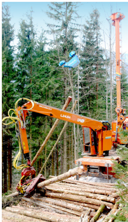
Der Syncrofalke 3 t von Unternehmer Herbert Pötz von der Sommeralm seilt bergauf mit dem Prisy-Laufwagen
